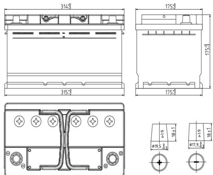
Bei Ruhespannung  $\leq 12,5$  V: Batterie nachladen
